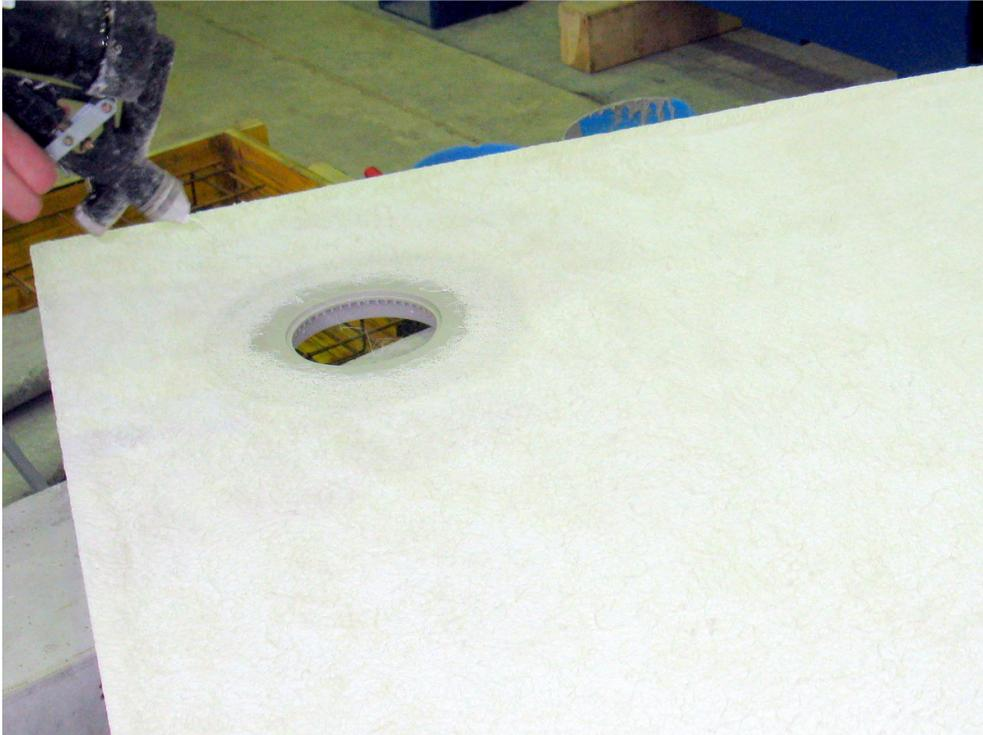
Bild 3 flächiger Auftrag des *Saxoboard Sprühklebers*
