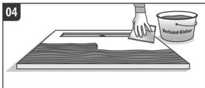
Auf der Rückseite des Duschelementes wird nun ein mineralischer Flexkleber mit einer 8-10 mm Zahnung vollflächig aufgetragen.
