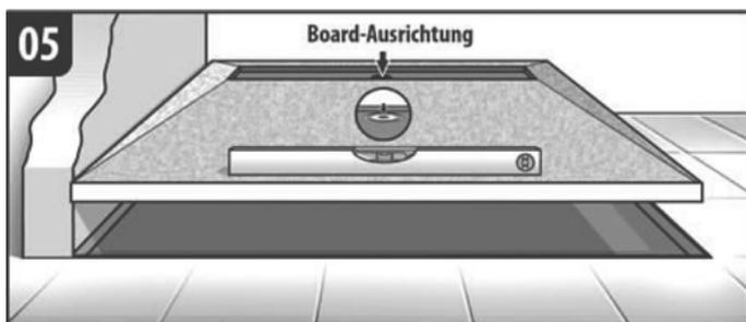
Das Duschelement wird nun passgenau und vollflächig auf den bereits vorhandenen Unterbau geklebt und ausgerichtet. (muss zwingend „frisch-in-frisch“ erfolgen)
