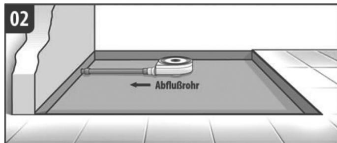
Der Geruchsverschluss ist mit dem Abflussrohr zu verbinden und entsprechend der Abflussposition des Elementes auf dem Rohfußboden zu positionieren.
