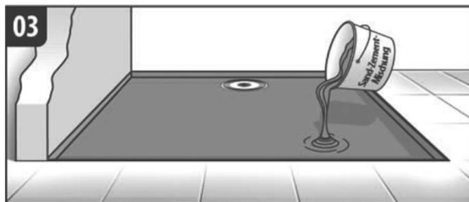
Eine Mörtelmischung (Sand/Zement) ist als Unterbau und tragende Schicht zu verwenden und eben einzubringen. (Alternativ SAXOBOARD-Unterbauelement)
