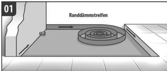
Zur Schallentkopplung ist ein Randdämmstreifen an den Wänden und zum angrenzenden Fußboden zu verwenden. (SAXOBOARD-Randdämmstreifen optional erhältlich)
