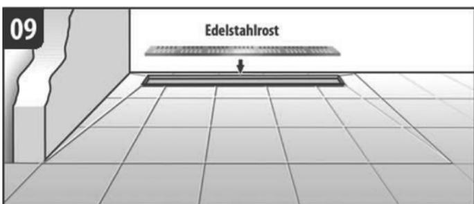
Am Designrost befestigen Sie nun letztendlich die beiliegenden schwarzen Clips und legen den Rost in die Mulde ein. Fertig! Beim Einsetzen der Roste muss auf die richtige Stellung der Stützfüße geachtet werden (bei Square nach innen, bei Panel und Fliesenmulde nach außen) !
