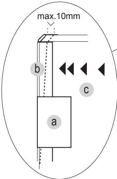
**D** Richten Sie das Festteil(c) senkrecht aus und schieben Sie das Kompensationsprofil(b) mit Druck an die Wand um Schrägen auszugleichen. Fixieren Sie dann mit den Wandbefestigungen(a). Bei gerader Wand kann auf das Kompensationsprofil(b) verzichtet werden und der senkrechte Wandanschluss absilikoniert werden (Abstand Wand / Glas min. 2 mm).
