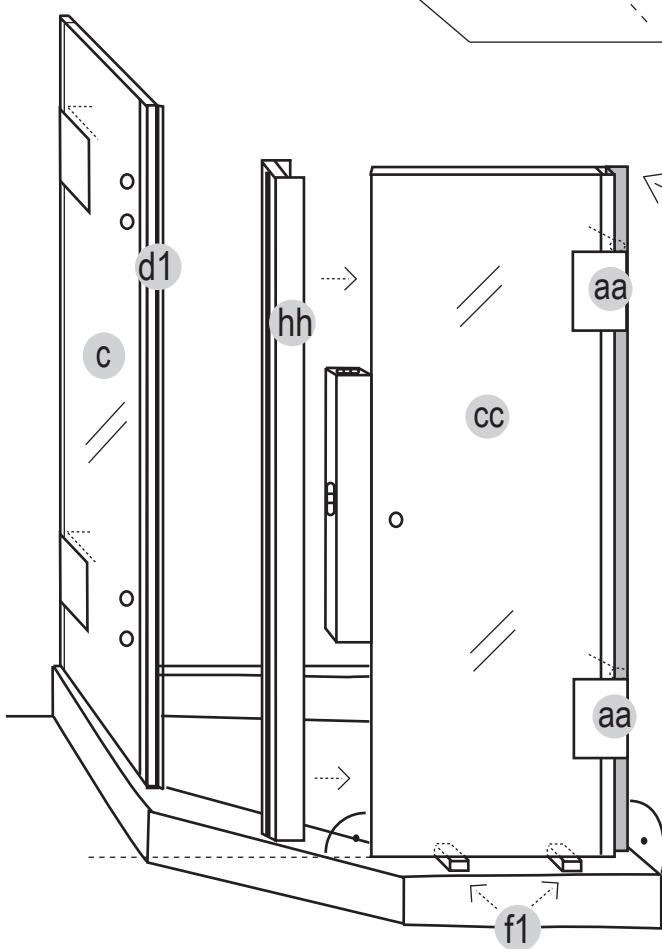
**I** Porre la porta verso l'interno(cc) in maniera verticale e spingere poi il profilo di compensazione(bb) verso la parete, in modo che chiuda dentro, attraverso la guarnizione, le fughe venutesi a creare tra il muro e la porta. Fissare poi il tutto con le cerniere(aa).
