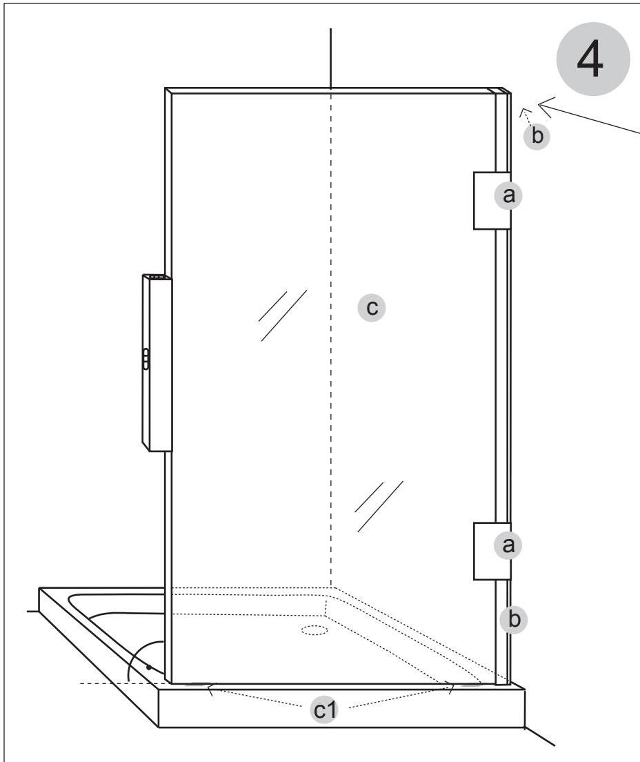
**D** Richten Sie die feste Seitenwand **c** senkrecht aus und schieben Sie das Kompensationsprofil **b** mit Druck an die Wand um Schrägen auszugleichen. Fixieren Sie dann mit den Wandbefestigungen **a**. Bei gerader Wand kann auf das Kompensationsprofil **b** verzichtet werden und dersenkrechte Wandanschluss absilikoniert werden (Abstand Wand / Glas min. 2 mm).
