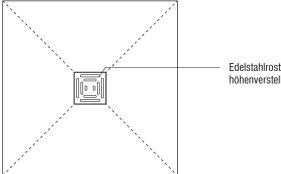
Edelstahlrost stufenlos höhenverstellbar / kürzbar 6 - 36 mm
